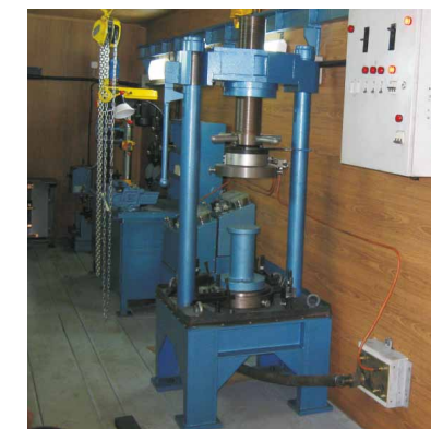
Стенд для испытания арматуры на прочность и герметичность водой и настройки предохранительных клапанов ИПГ-11-15
