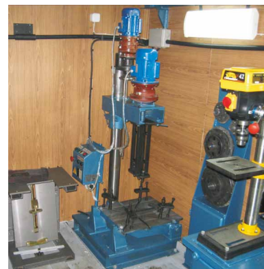
Стенд для шлифования и притирки уплотнительных поверхностей корпусов и клиньев задвижек СПШ-1-1
