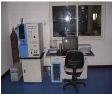
Рентгеноскопический анализ углерода и серы.
