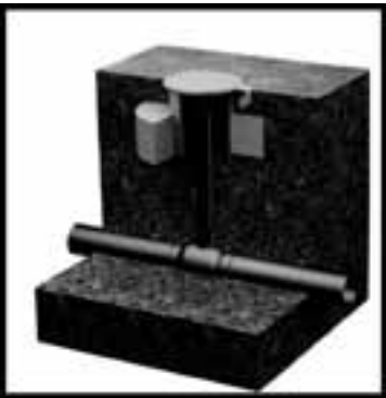
Подземный кран, установка под ковер
