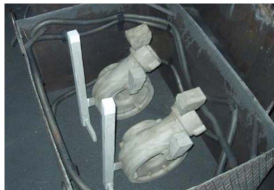
Рис. 3. Расположение моделей на песчаной «постели» при формовке в контейнерной опоке (фото Н. В. Бабича).
