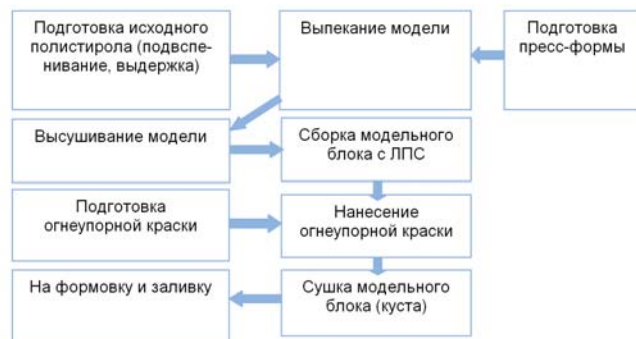
Рис. 1. Последовательность технологических операций получения модели автоклавным способом.
