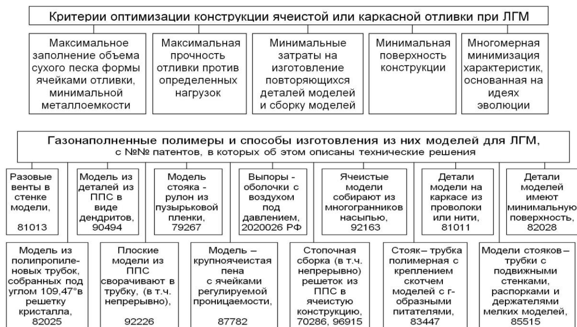
Рис. 10. Критерии оптимизации ячеистых отливок, новые газифицируемые материалы и способы изготовления моделей ячеистых отливок для ЛГМ (14 патентов).
