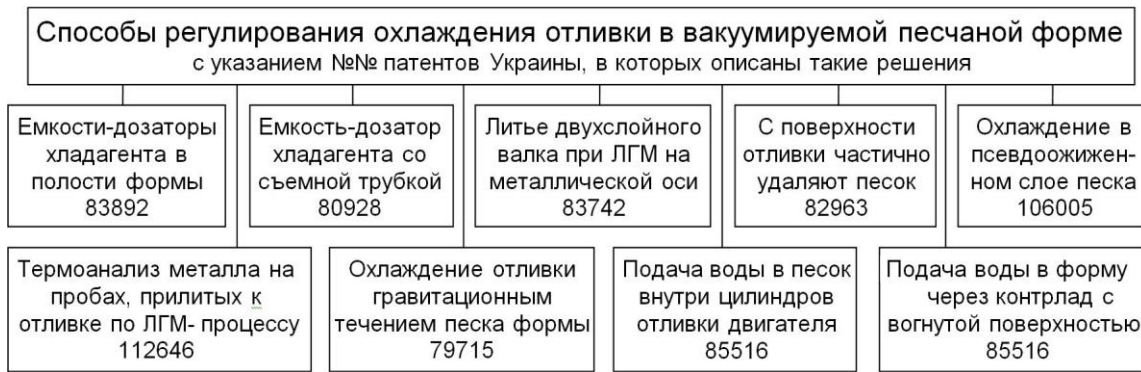
Рис. 6. Новые технические решения по регулированию охлаждения отливки в форме.
