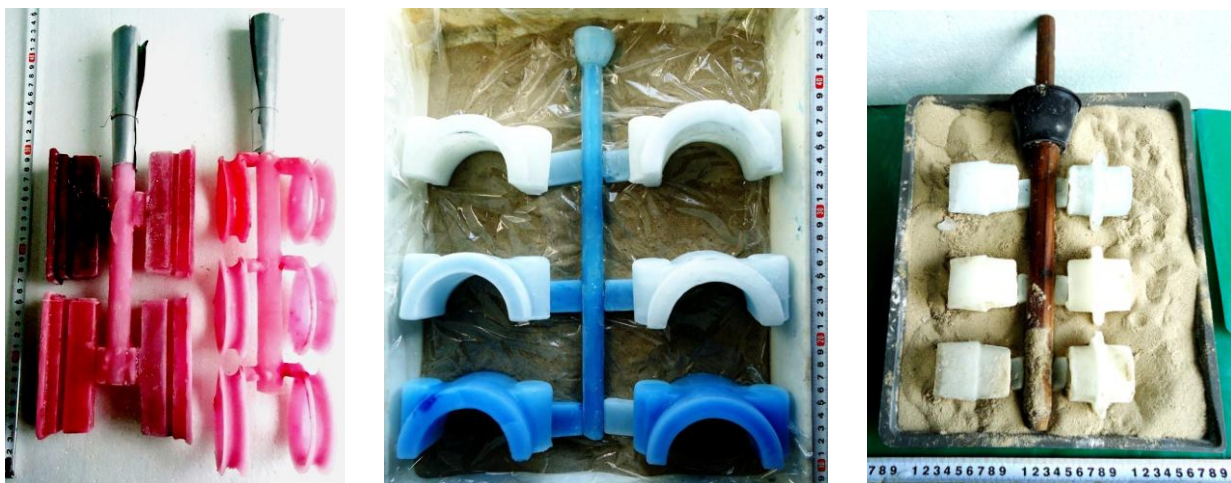
Рис. 21. Сборка блоков на пенопластовой подкладке и «постели» из охлажденного песка.
