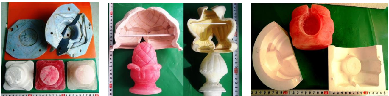
Рис. 22. Оснастка из стеклопластика, резины и пенополистирола и ЛМ, полученные по ней.
