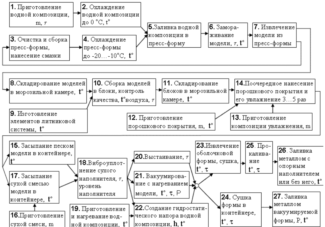
Рис. 31. Схема процесса литья по ледяным моделям.
