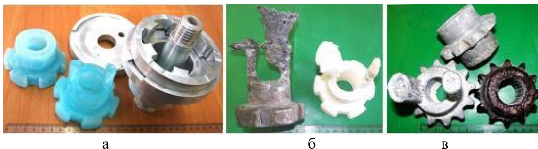
Рис. 19. Модели: полумуфт с пресс-формой, окрашенный лед (а); ЛМ с жидким стеклом и чугунная отливка (б); звездочки конвейера (с лигносульфонатами ЛСТ – темного цвета) с двумя отливками (в).
