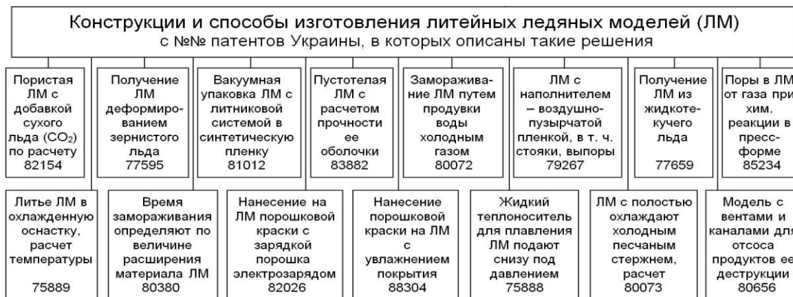
Рис. 25. Конструкции ледяных моделей и структура исследований и разработок в области формовки по этим моделям.
