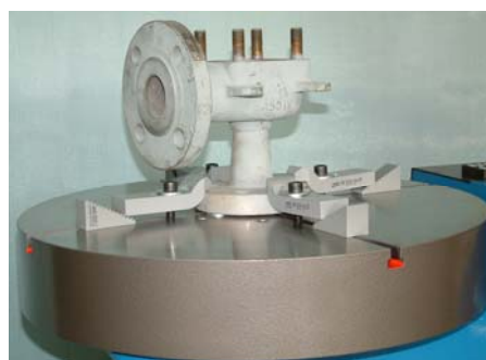
Поворотный стол с предохранительным клапаном
