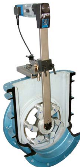
HSL-15 устанавливается прямо на задвижку
