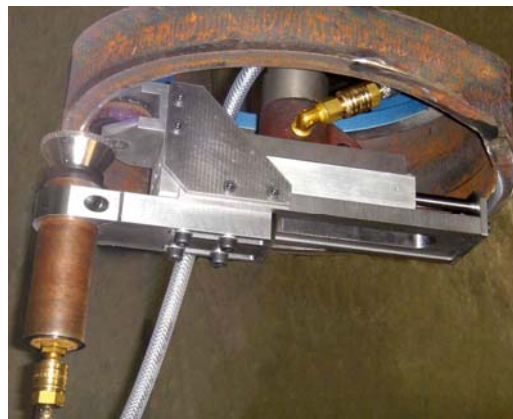
Приспособление для шлифования люков
