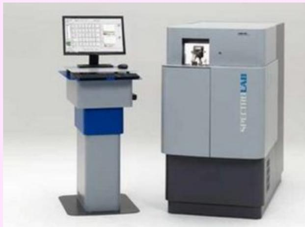
емам работы с новым прибором, освоены методики анализа, после чего прибор прошел опытные испытания на образцах металлов и сплавов в лаборатории сварки Отдела главного сварщика.
