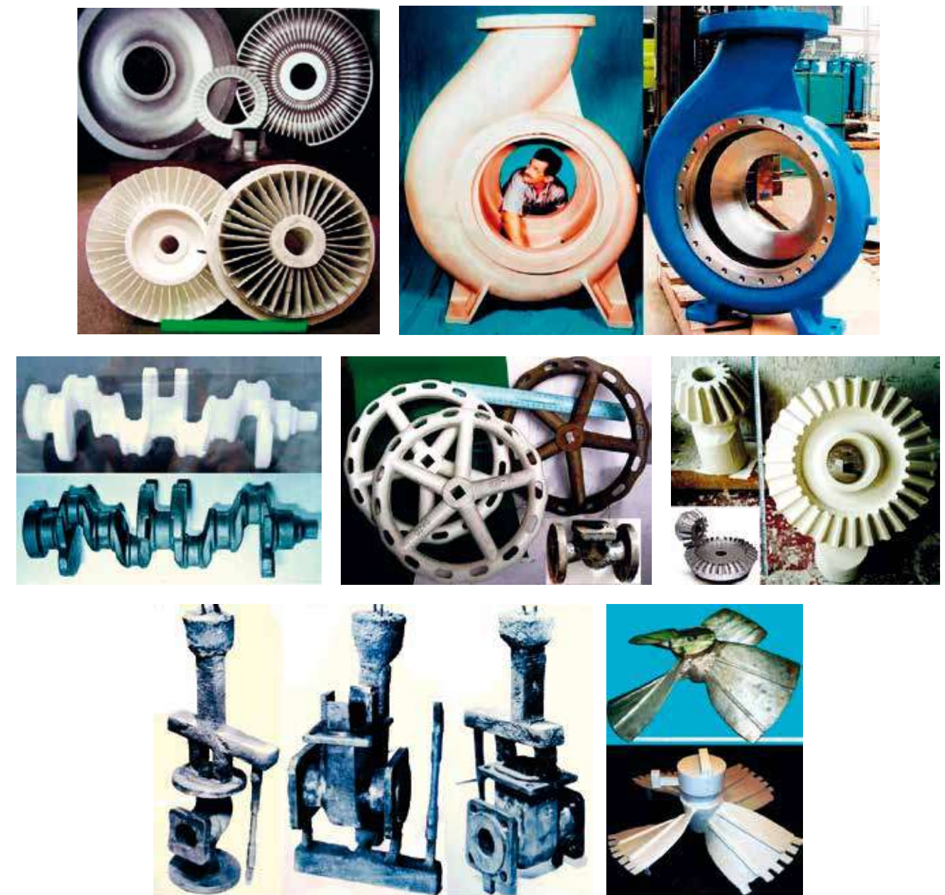
Рис. 3. Типичные примеры отливок и пенопластовых моделей, получаемых в современных литейных цехах при литье в вакуумируемые песчаные формы
