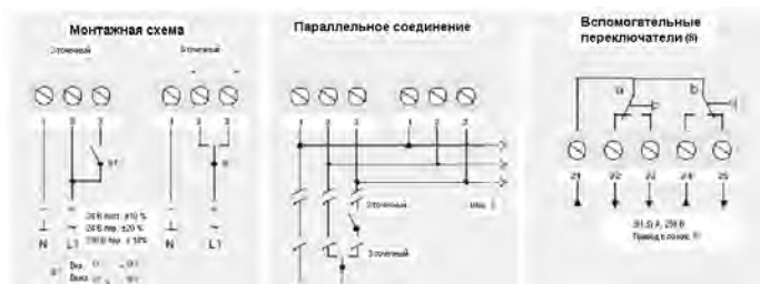
Специальный 2- и 3-точ. электрический демпферный актуатор
