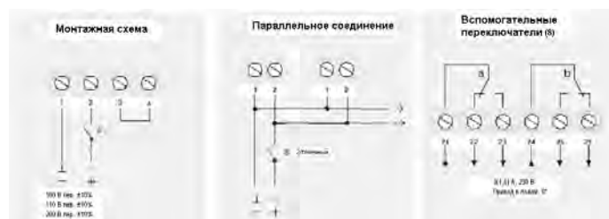
Специальный 2-точ. электрический демпферный актуатор с пружинным возвратом
