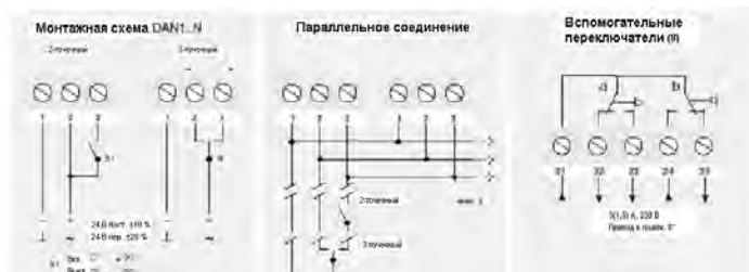
Специальный 2- и 3-точ. электрический демпферный актуатор
