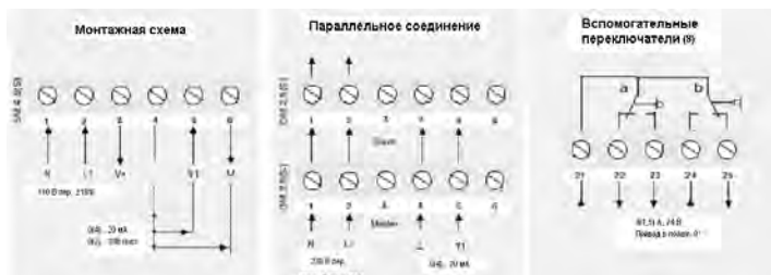
Специальный электрический демпферный актуатор для плавного регулирования
