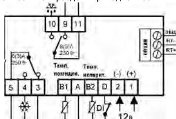
Схема разводки MR43PM12R-2C
