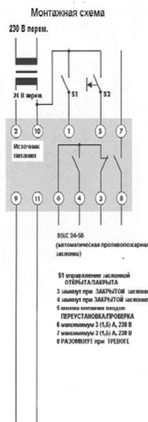
Кабельные подключения Диаграмма
