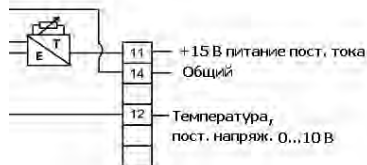
Кабельные подключения RS-1140-0000
