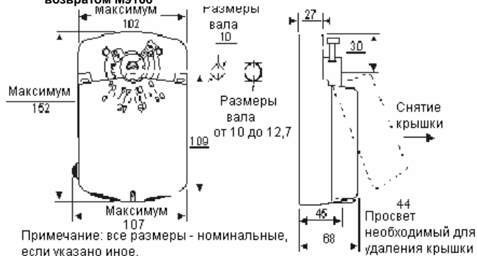
Актуатор с безпружинным возвратом M9106
