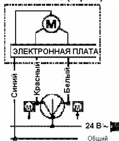
Кабельные подключения Диаграмма моделей, регулирующих по приращению
