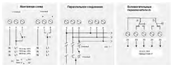
Специальный 2- и 3 точ. электрический демпферный актуатор
