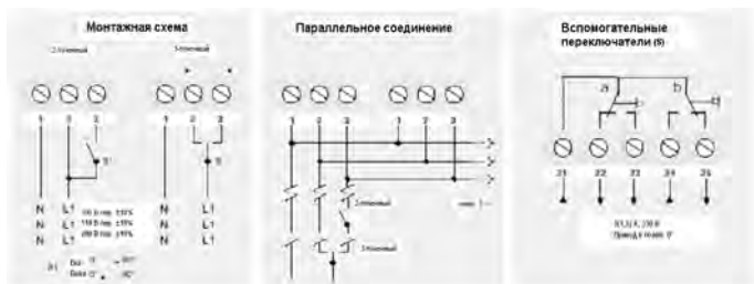
Специальный 2- и 3 точ. электрический демпферный актуатор
