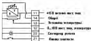
Кабельные подключения RS-1160-0000 и RS-1160-0005
