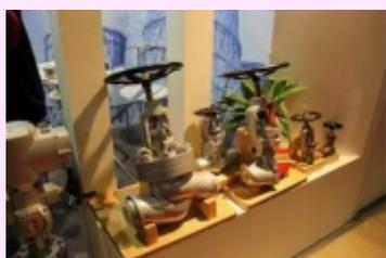
стали: комбинированный всережимный регулирующий питательный клапан для котлов, способный заменить собою два традиционных, высокоточные парохладители и компактные клапаны РОУ /БРОУ.
