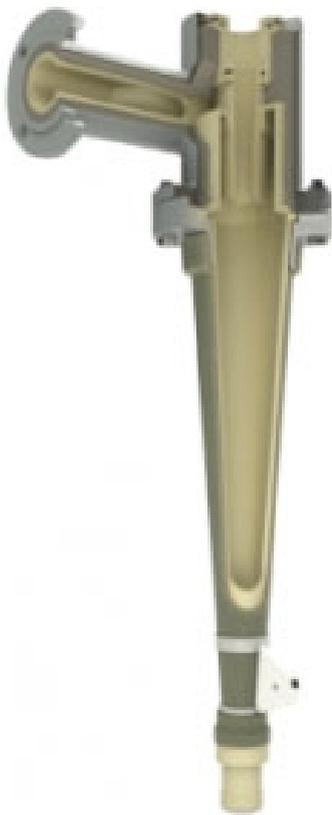
тан керамический гидроциклон. Гидроциклон – аппарат, в котором происходит очистка рабочей среды от посторонних примесей под действием центробежной силы. Он идеально подходит для обесшламливания, сгущения шлам и продуктов флотации, осветления оборотных вод, классификации рудной пульпы в стадиях тонкого измельчения в
