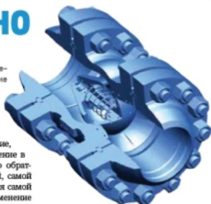
3D-модель осесимметричного обратного клапана
