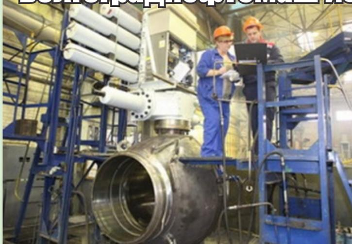
В ОАО «Волгограднефтемаш» успешно завершились испытания шаровых кранов DN 1000 мм и DN 700 мм с электрогидроприводом.
