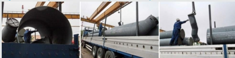
ЗАО «Энергомаш (Белгород) – БЗЭМ» изготовило и отгрузило очередную партию сильфонных компенсаторов для технического перевооружения пылеугольного энер-
