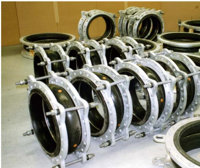
Резиновые компенсаторы являются стандартной продукцией, т.е. присоединительные фланцы изготавливаются по ГОСТ и DIN, в зависимости от проходного диаметра и давления. Компенсаторы по желанию заказчика комплектуются ограничительными штангами, для ограничения действия распорных усилий. Штанги изготавливаются также с карданным шарниром.
